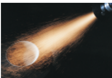
Proceso de reforzamiento con aspersión por arco
