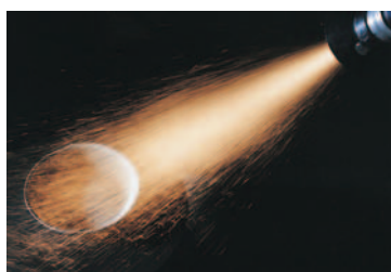
Электродуговое нанесение усиления для покрытия Excalibur.
