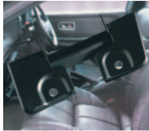
Gepreßter Stahl, Gurtsäulenhaltung beschichtet mit Xylan, unterstützt die Sicherheit der Anwendung.
