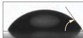
Le meilleur des concurrents après usure : l'angle de contact = 58.1°
