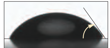
Bester Mitbewerber nach Abriebtest: Kontaktwinkel = 58,1°
